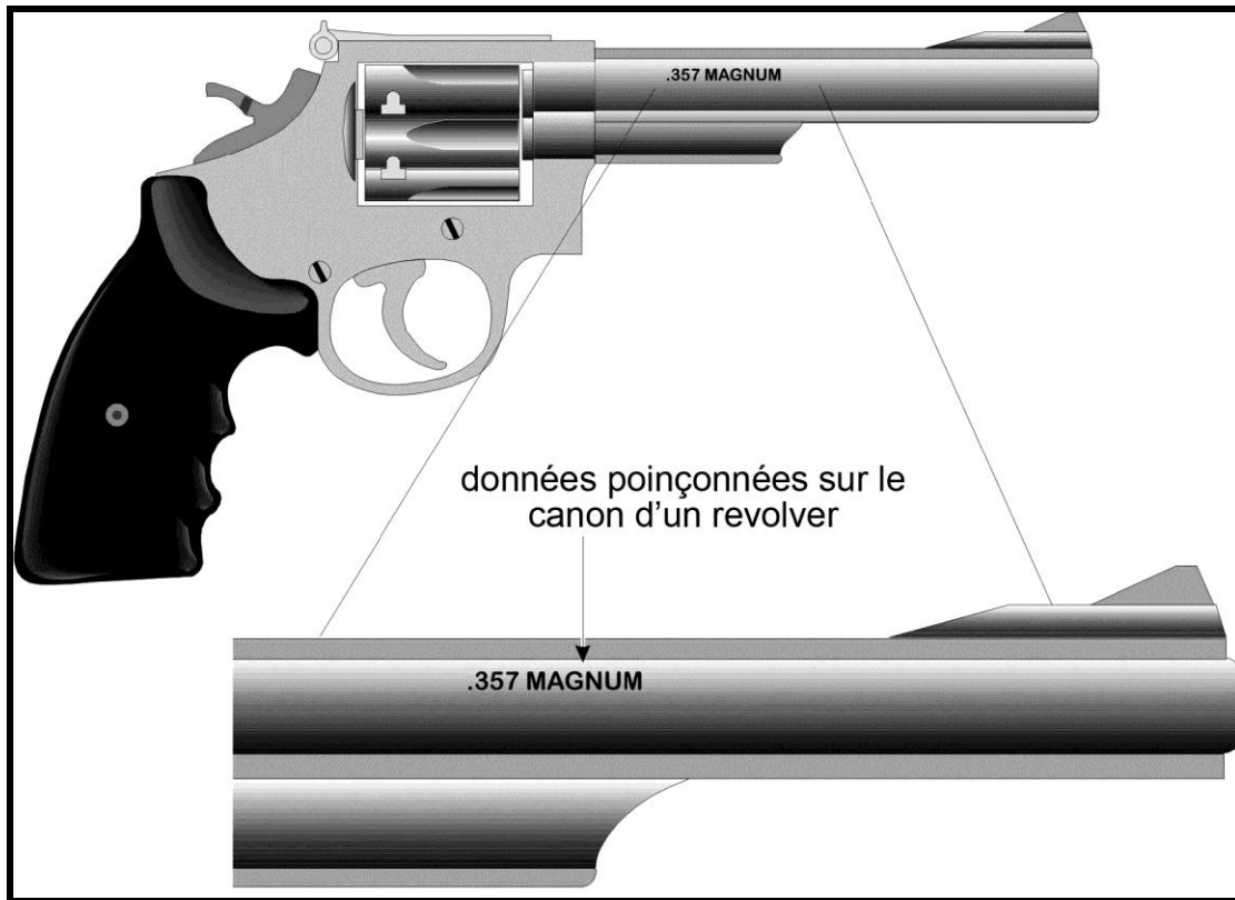
Figure 93. Exemple d'un poinçon de canon
